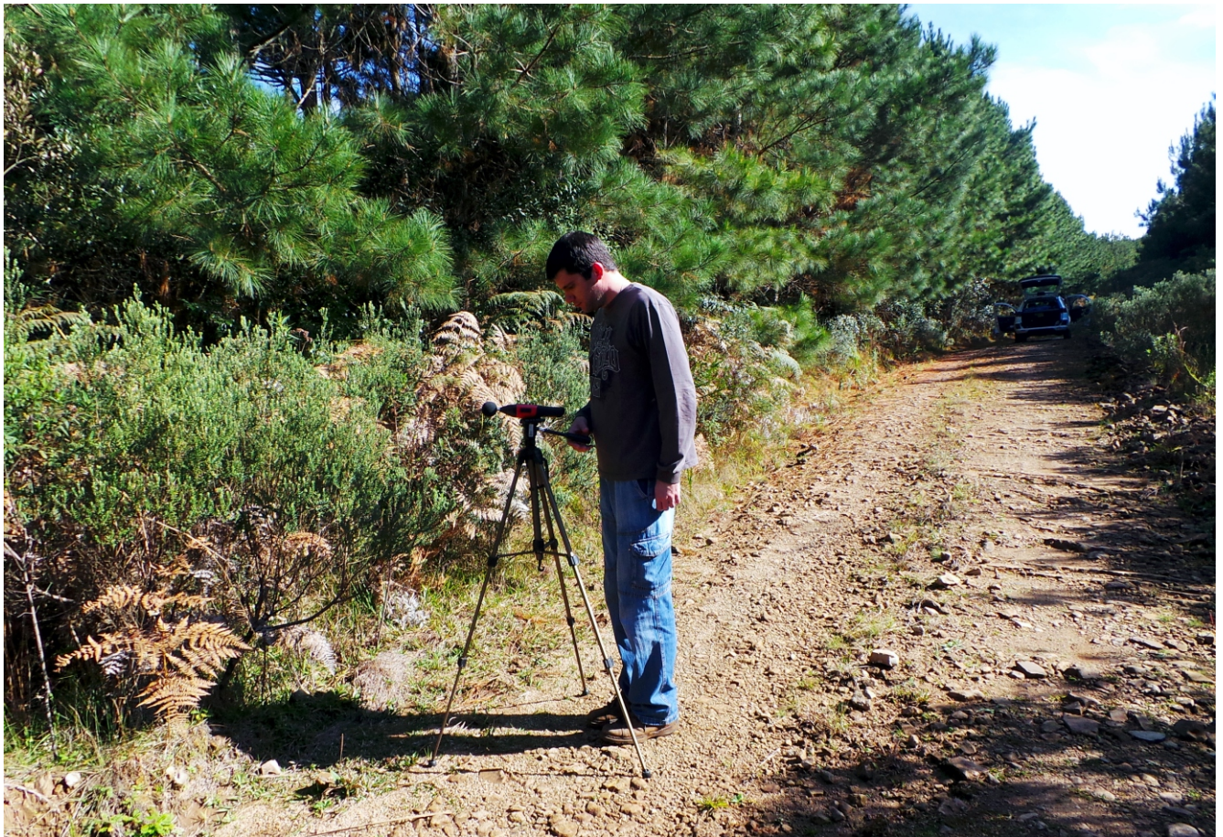
Figura 9 - Realização do diagnóstico ambiental pela equipe de campo na área de influência (medição de ruídos).
