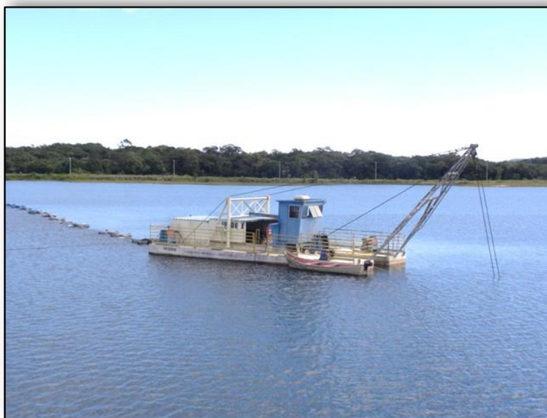
Foto 2.01. Draga em Operação na Lagoa de Extração.
