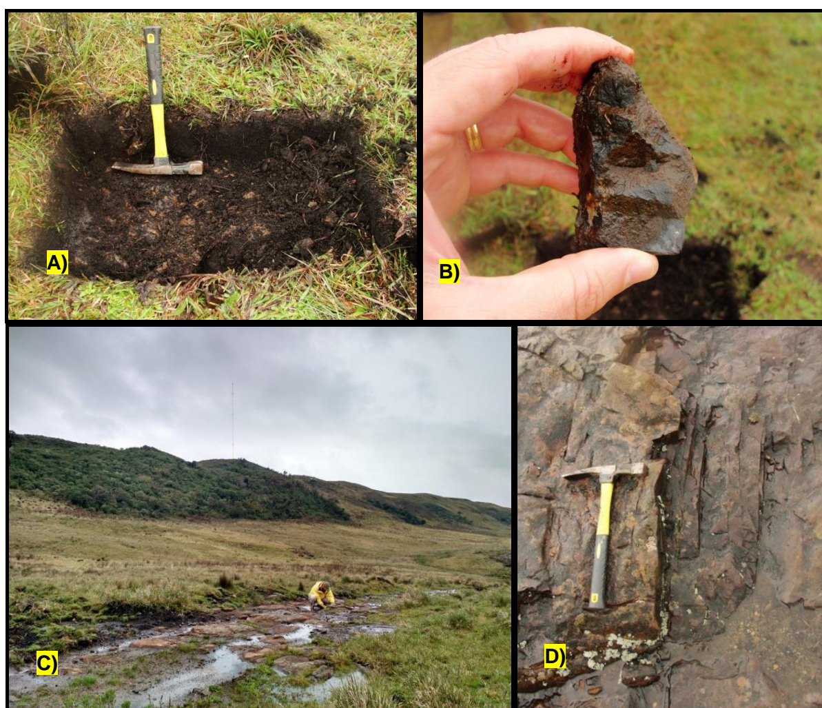
Fig. 4.2 - A) Cobertura de solo sobre a laje de rocha basáltica na região da subestação; B) Característica da rocha de basalto; C) Coleta de amostra para análise do material; D) Detalhe da estrutura de rocha
