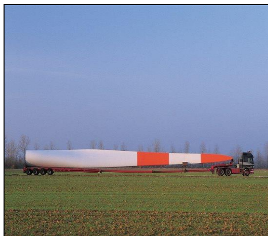
Fig. 3.9 - Transporte terrestre de uma das pás que compõe o rotor.
