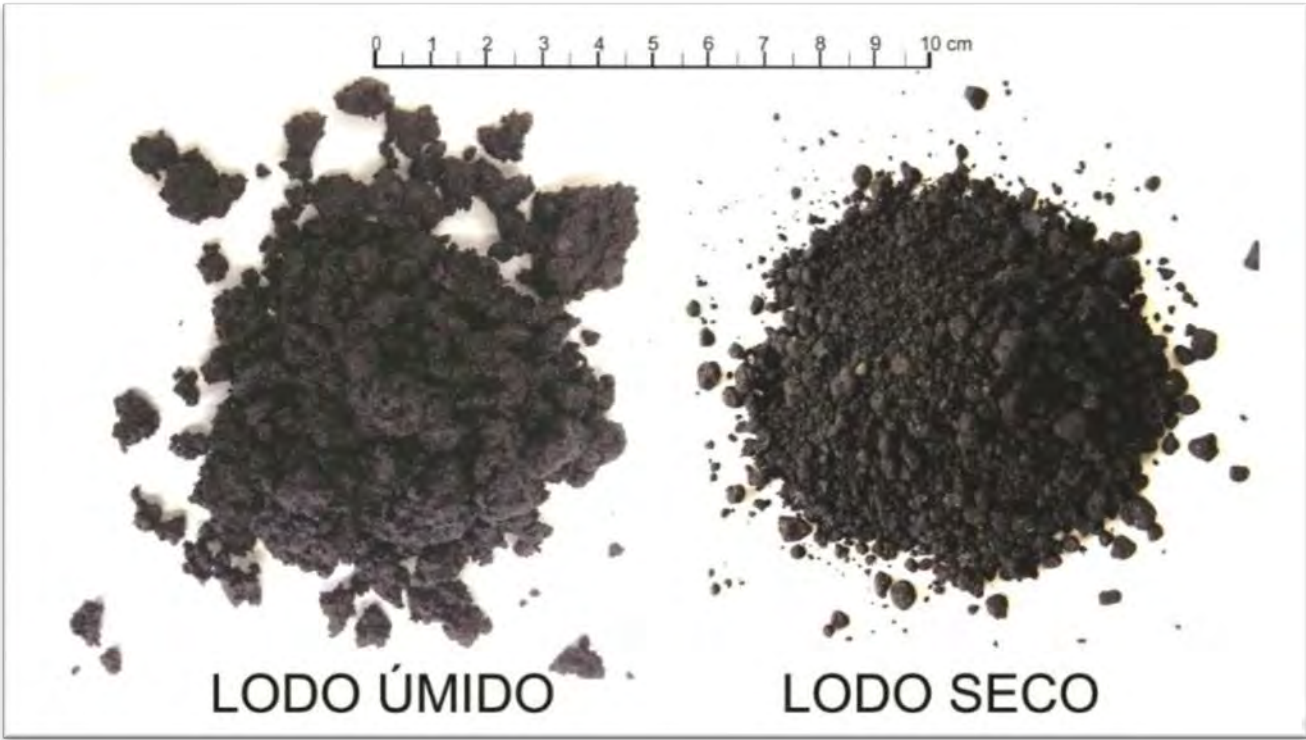
Figura 18 – Diferença visual do lodo úmido (entrada secador) e lodo seco saída do secador.
