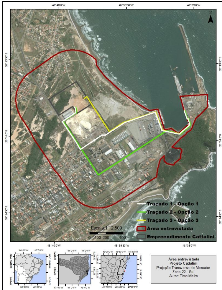
Figura 8-38 – Área do empreendimento, localização das alternativas locais do duto de acesso ao porto de Imituba, demonstrando a opção escolhida (opção 03) em amarelo..
