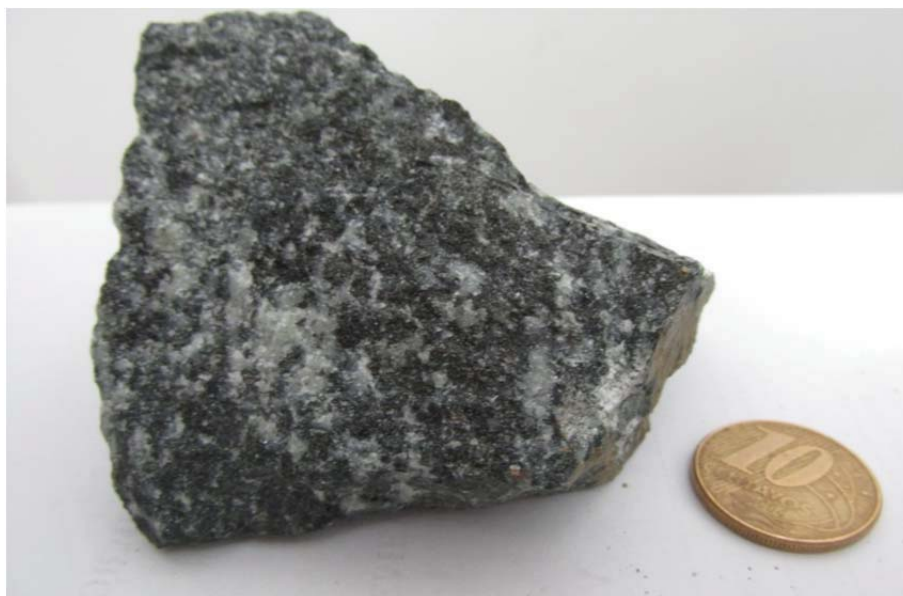
Figura 6-9: Gnaiss granulítico homogêneo. Fonte: do autor.
