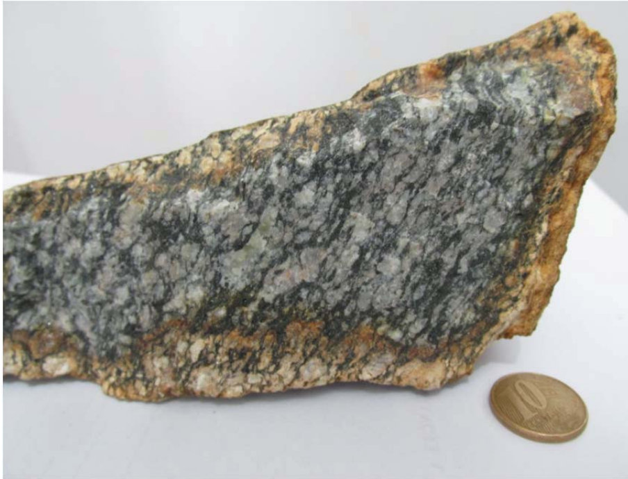
Figura 6-10: Amostra do gnaiss com bordas de alteração. Fonte: do autor.
