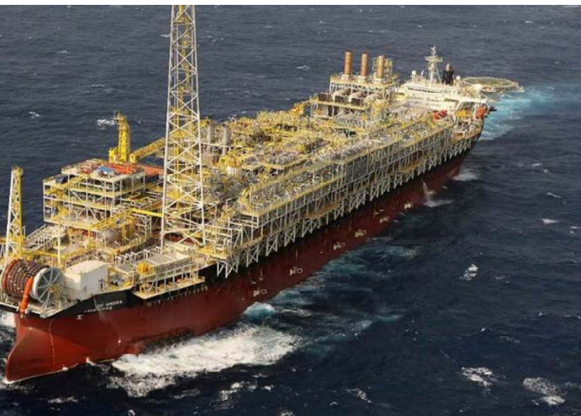
◀ Figura 3. Embarcação do tipo FPSO com modulação completa (Floating, Production, Storage and Offloading – Unidade flutuante de armazenamento e transferência).
