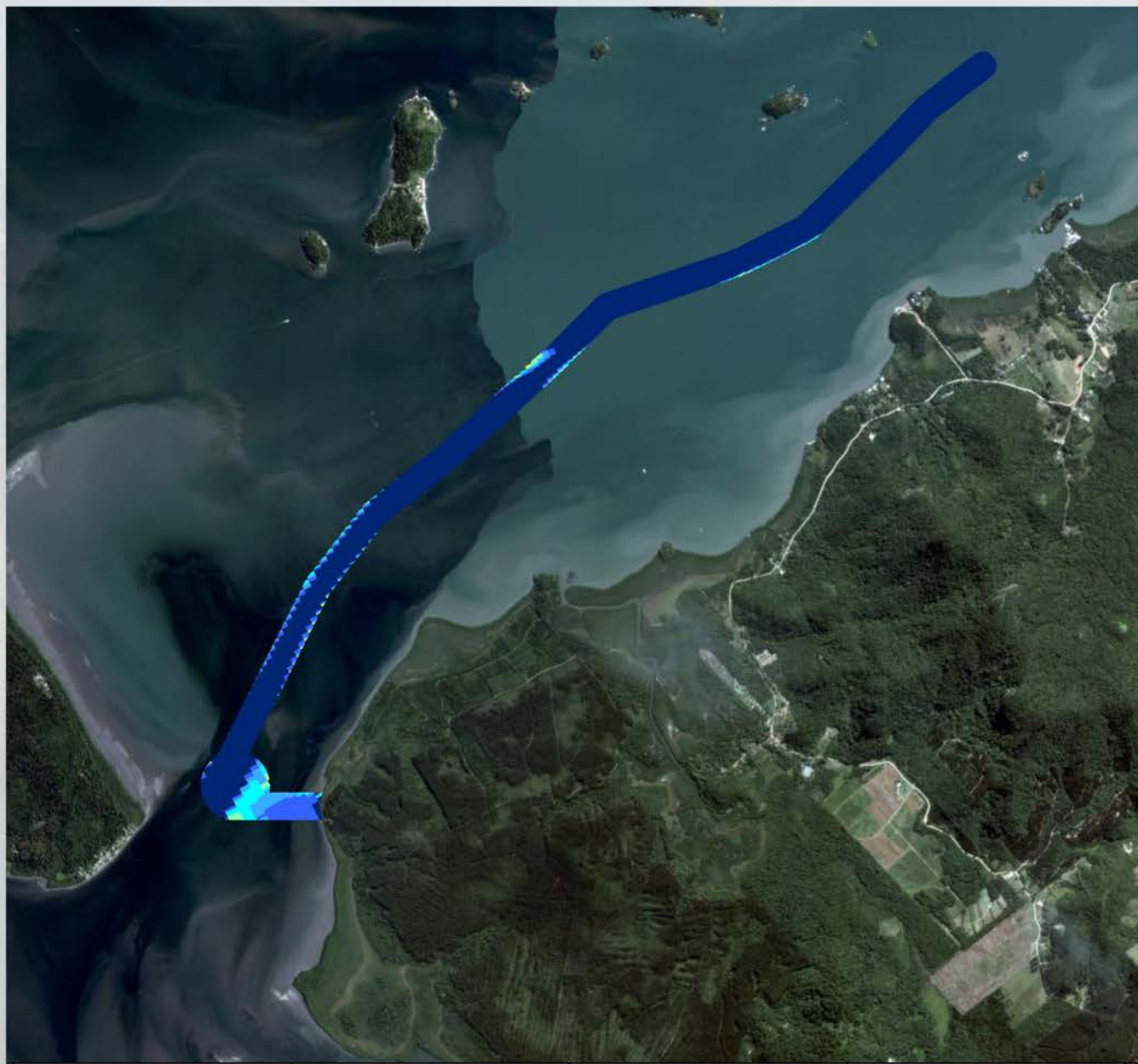
Figura 33 - b. Batimetria em relação à cota do projeto de 8 metros de profundidade para o canal de acesso após 1 ano de simulação morfológica.
