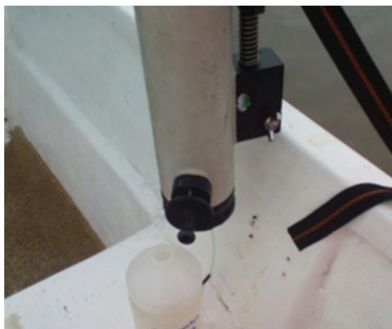
Coleta de fitoplâncton com garrafa de Niskin.
