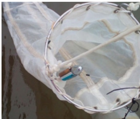
Coleta de zooplâncton com rede de malha 200 mm equipada com fluxômetro.
