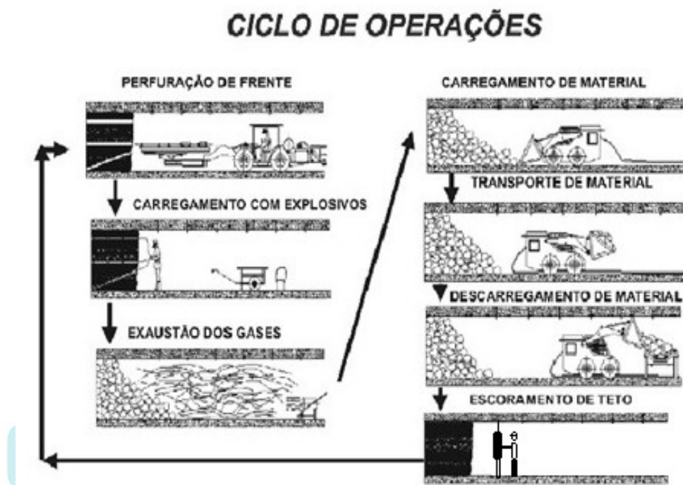
Figura 4 – Desenho esquemático do ciclo de operação da frente de lavra (fonte: Mine Blog por Darcy José Germani – desenho cedido pela Carbonífera Criciúma AS, modificado).
