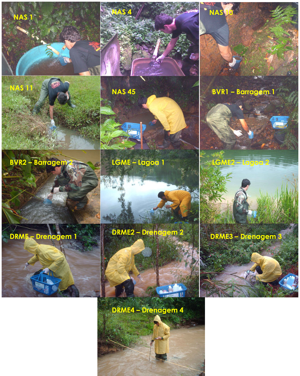
Figura 16 – Detalhes das coletas de água e medidas de vazão dos pontos de monitoramento.
