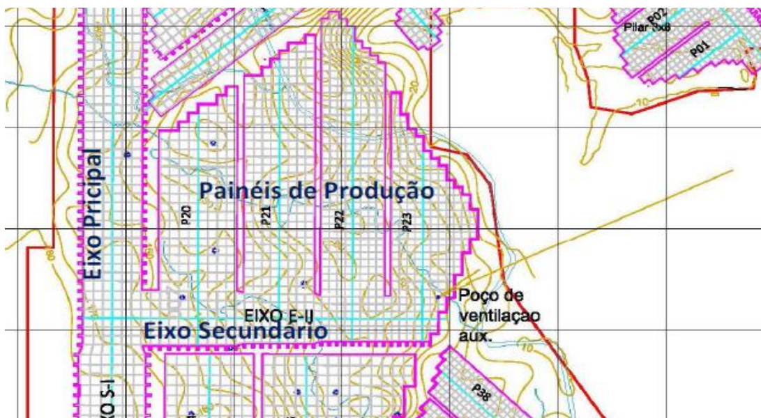
Figura 2: Layout operacional dos eixos principais, secundários e painéis produtivos.
