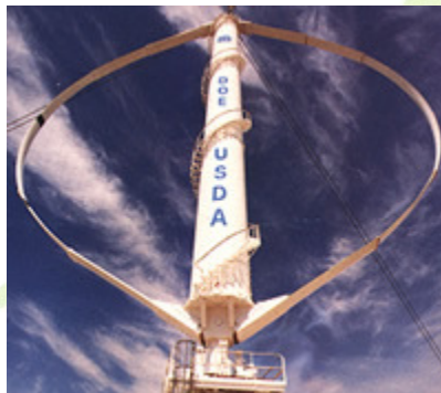
Figura 3 – Aerogerador de Eixo Vertical Fonte: CRESESB (2011)
