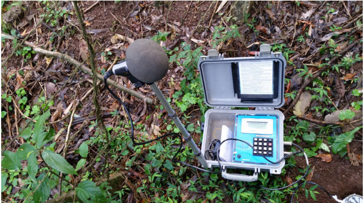
Foto 03: Microfone instalado, Paio de explosivos. (Distância de 596,45 metros do local do desmonte).
