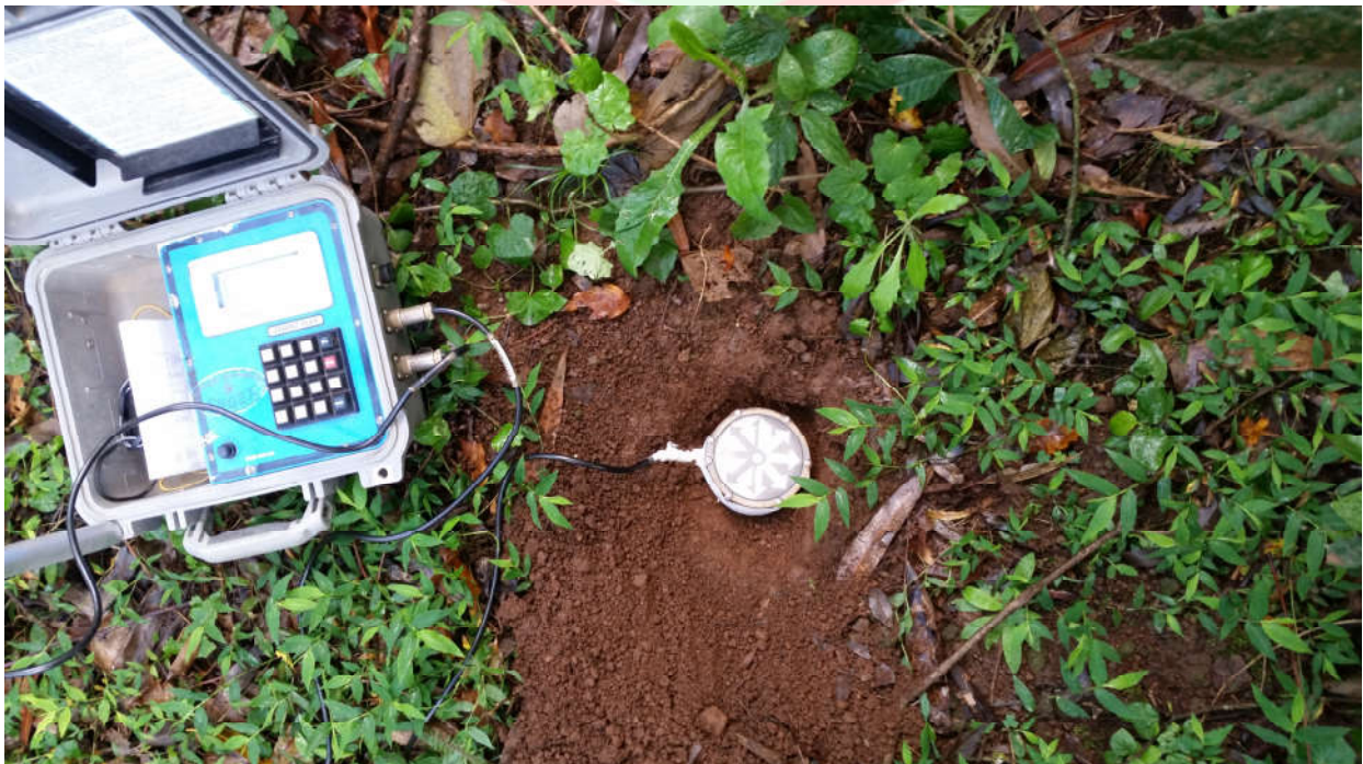
Foto 02: Geofone instalado, Paio de explosivos. (Distância de 596,45 metros do local do desmonte).
