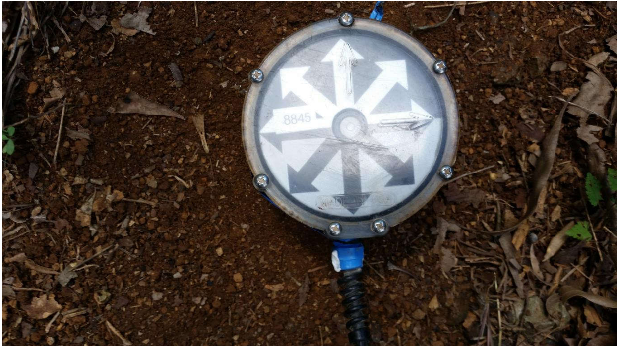
Geofone no depósito de explosivo, com a distância de 000 metros do local do desmonte.
