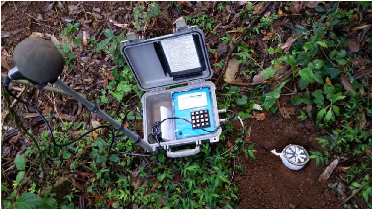
Foto 01: Local de captação sismográfica, Paio de explosivos. (Distância de 596,45 metros do local do Desmonte).
