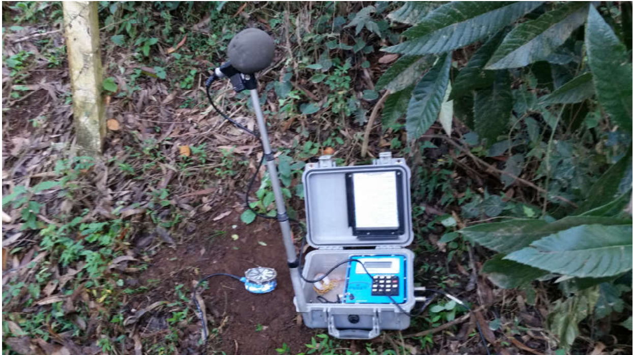
Foto 01: Local de captação sismográfica, Paiol de explosivos. (Distância de 630,35 metros do local do Desmonte).
