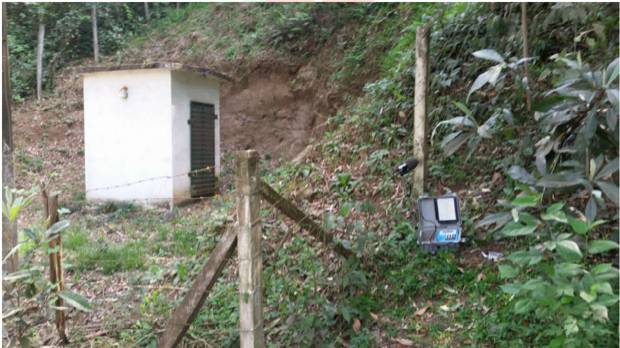
Foto 04: Local onde foi instalado o sismógrafo, sendo este, Paio de explosivos, em uma distância de 605.64 metros do local do desmonte.
