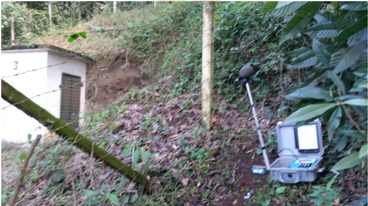
Foto 04: Local onde foi instalado o sismógrafo, sendo este, PaioI de explosivos, em uma distância de 630,35 metros do local do desmonte.
