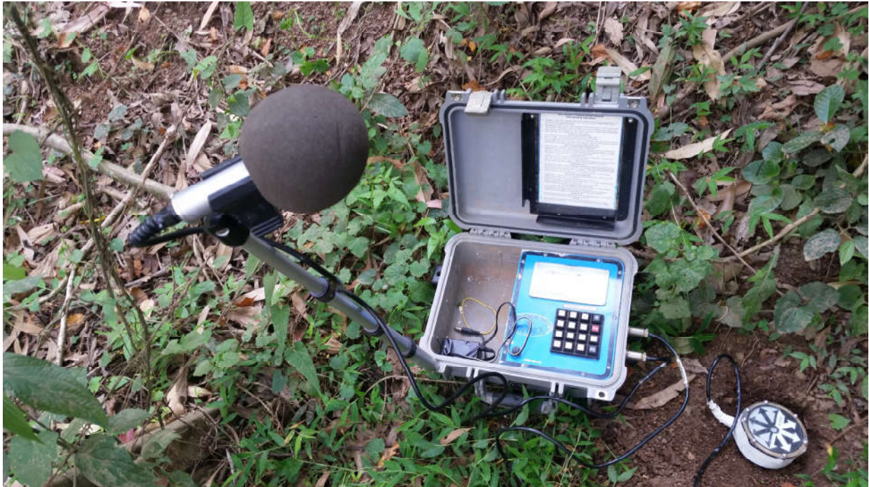
Foto 03: Microfone instalado, Paio de explosivos. (Distância de 605.64 metros do local do desmonte).
