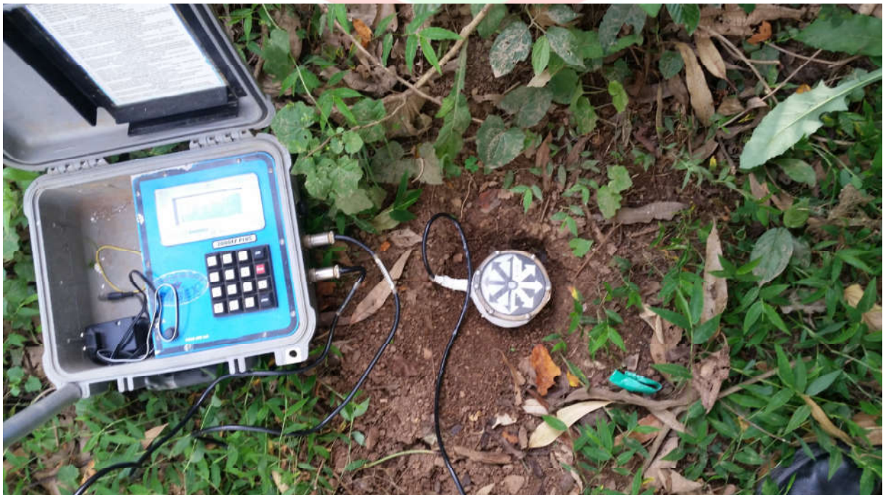
Foto 02: Geofone instalado, Paio de explosivos. (Distância de 605.64 metros do local do desmonte).
