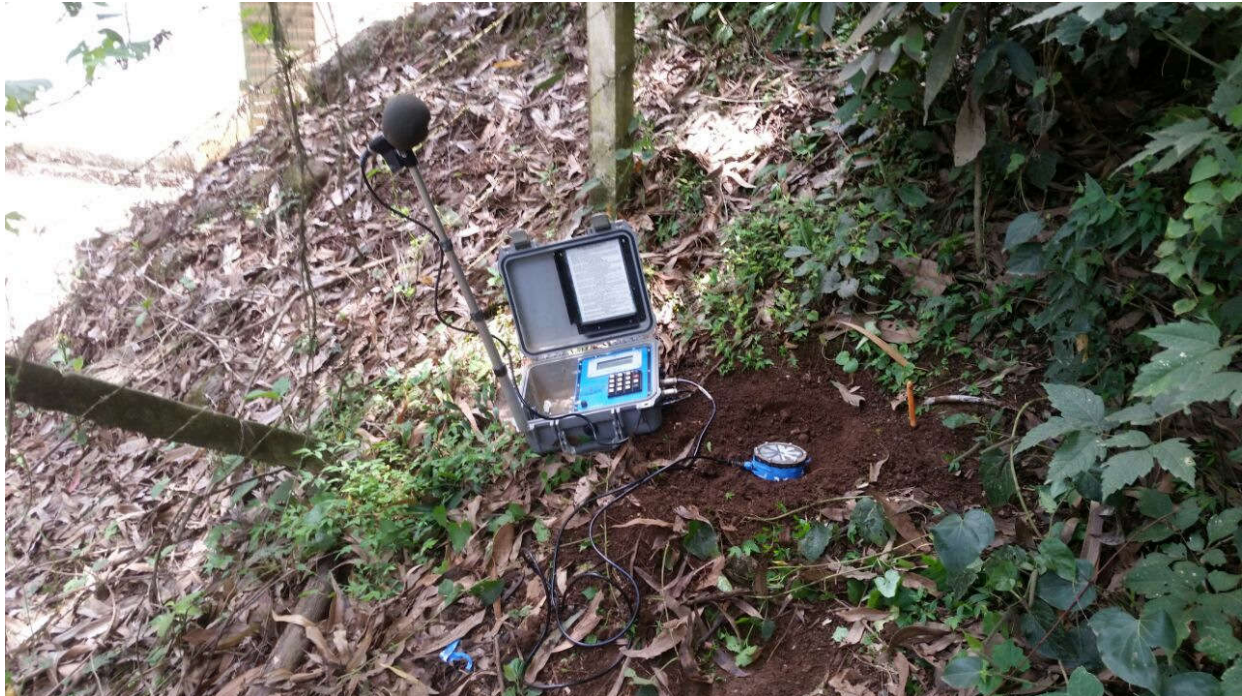
Foto 01: Local de captação sismográfica, Paiol de explosivos. (Distância de 590,26 metros do local do Desmonte).
