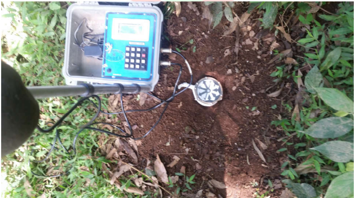
Foto 02: Geofone instalado, Paioi de explosivos. (Distância de 619,56 metros do local do desmonte).
