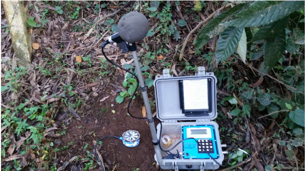
Foto 03: Microfone instalado, PaioI de explosivos. (Distância de 630,35 metros do local do desmonte).
