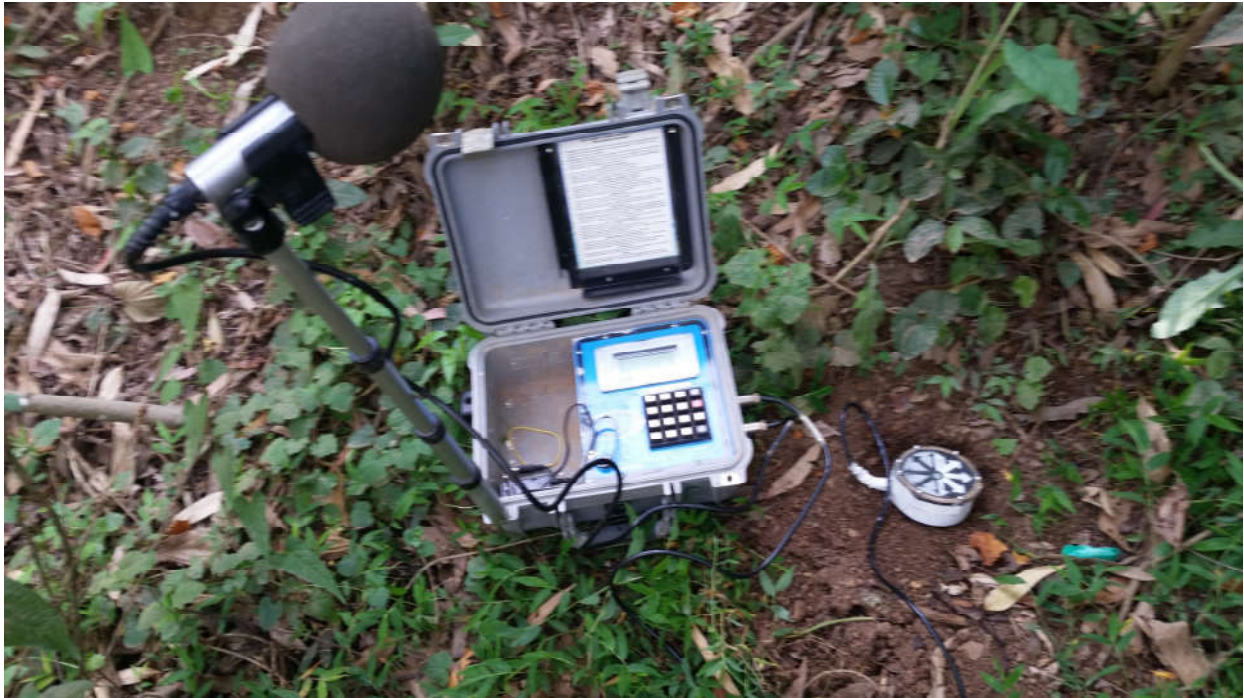
Foto 01: Local de captação sismográfica, Paio de explosivos. (Distância de 605.64 metros do local do Desmonte).
