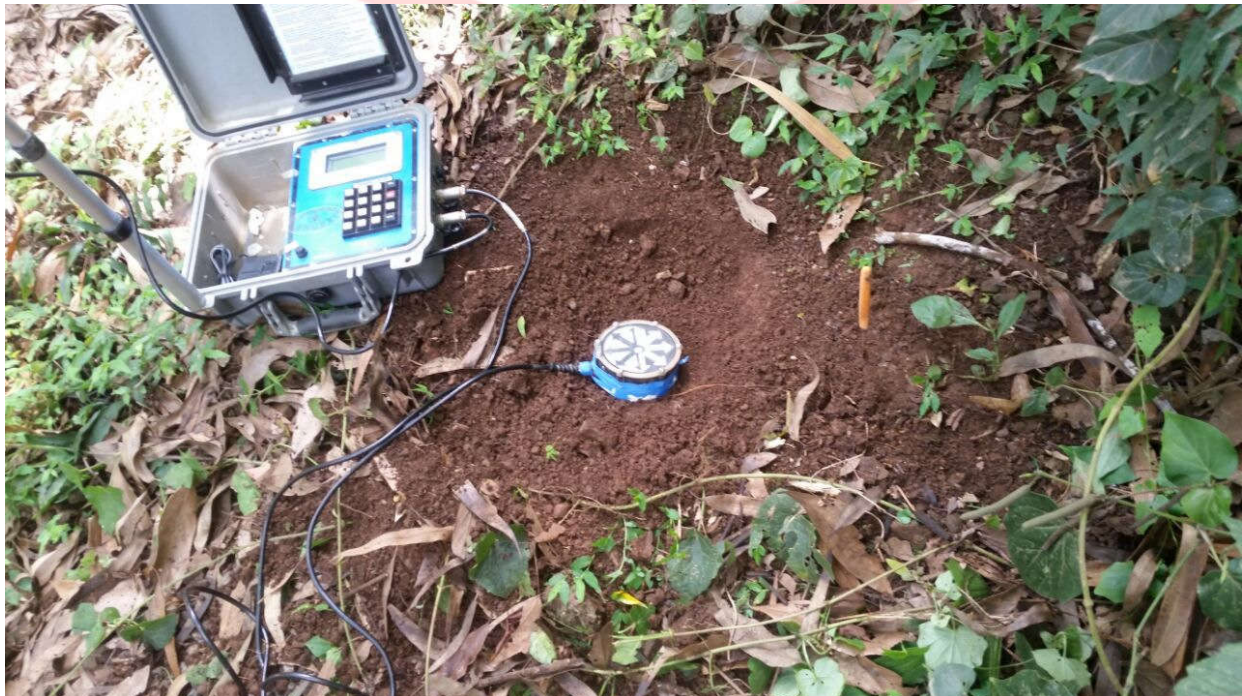
Foto 02: Geofone instalado, Paiol de explosivos. (Distância de 590,26 metros do local do desmonte).
