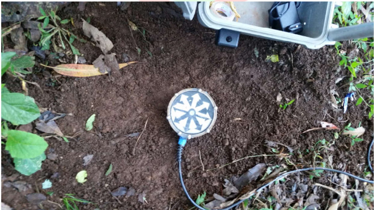
Foto 02: Geofone instalado, Paiol de explosivos. (Distância de 630,35 metros do local do desmonte).
