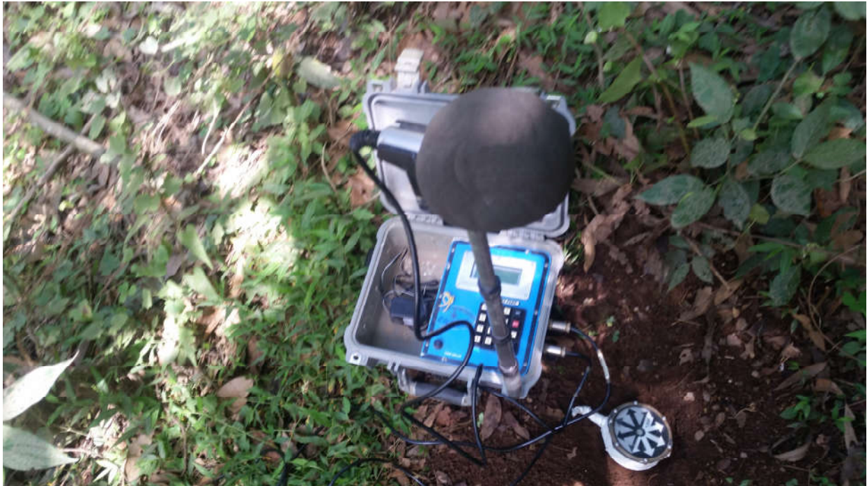
Foto 03: Microfone instalado, Paio de explosivos. (Distância de 619,56 metros do local do desmonte).
