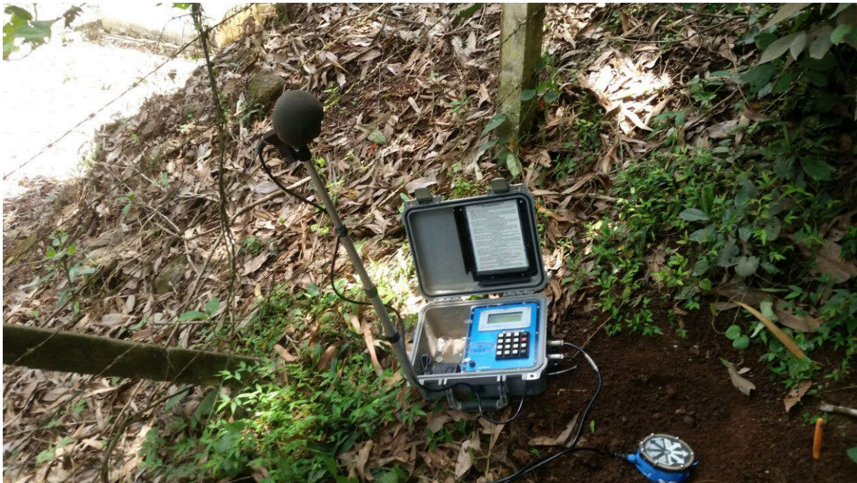
Foto 03: Microfone instalado, Paiol de explosivos. (Distância de 590,26 metros do local do desmonte).
