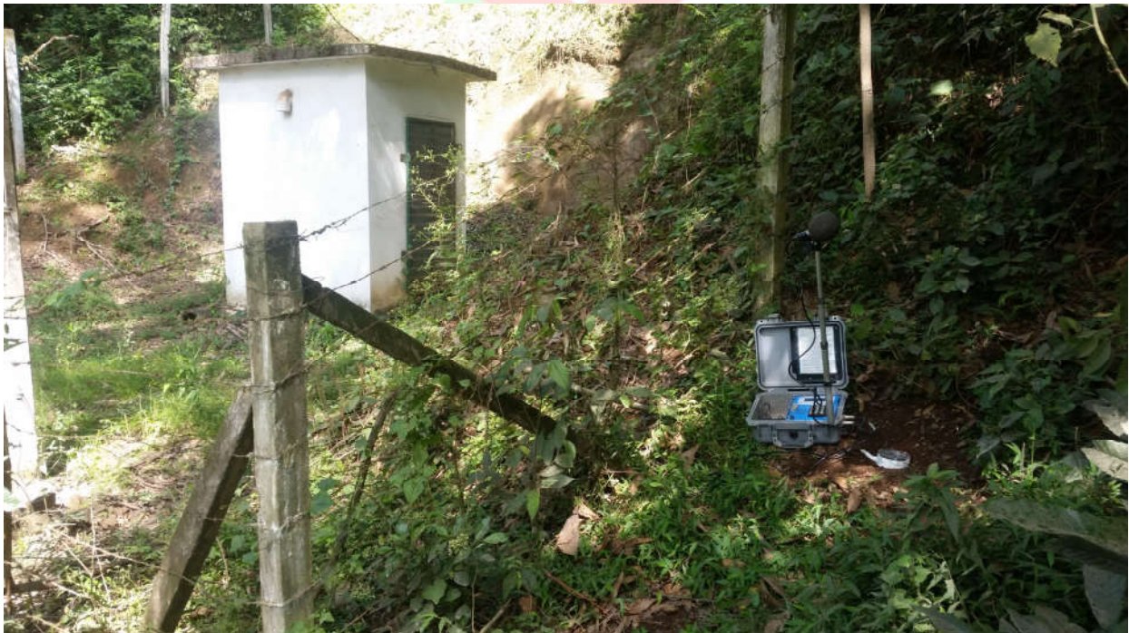
Foto 04: Local onde foi instalado o sismógrafo, sendo este, Paio de explosivos, em uma distância de 619,56 metros do local do desmonte.
