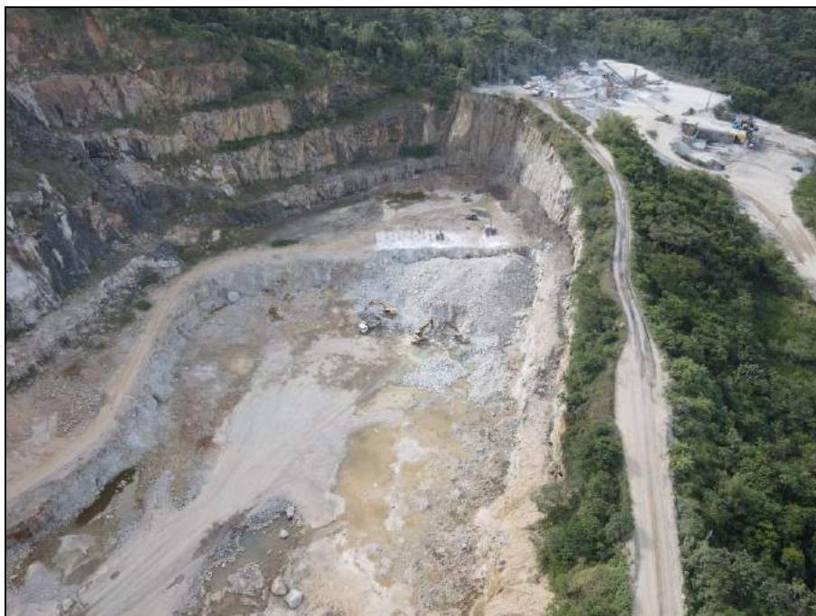
Figura 6-7: Mina de granito em operação no local com as devidas autorizações dos órgãos públicos competentes, sendo evidente a formação dos taludes na encosta e no rebaixamento.
