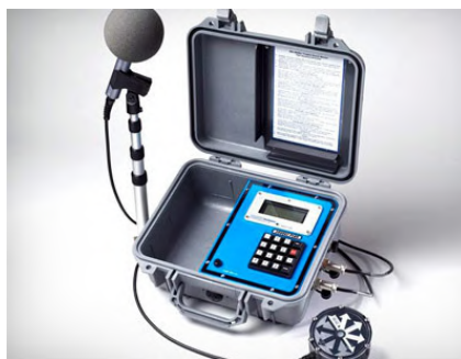
Sismógrafo utilizado para registro de vibração e pressão acústica
