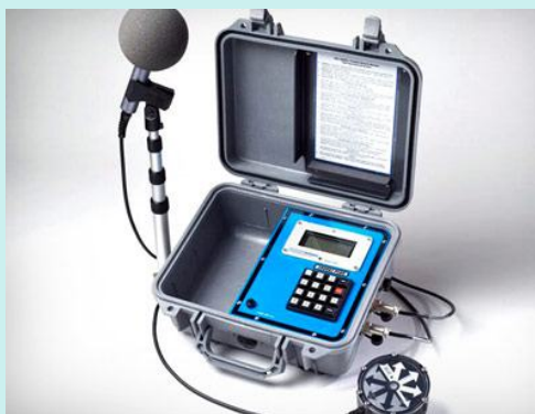
Modelo de sismógrafo utilizado para registro de vibrações e pressão acústica provenientes de detonação
