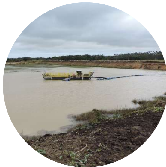
Lavra de areia por draga flutuante em cava inundada na mina Morro Bonito.
