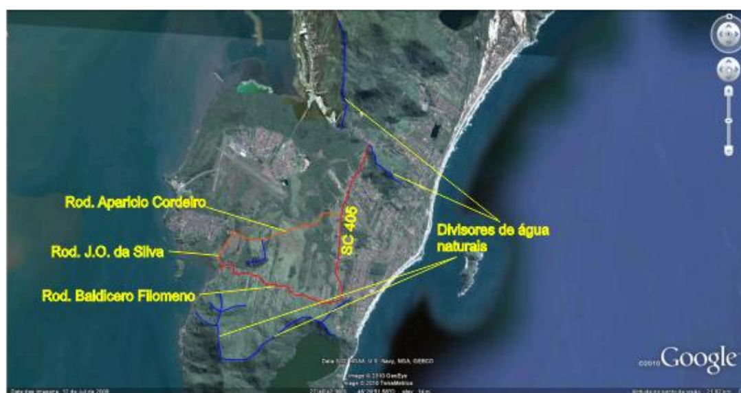
Localização das estradas e divisores de água naturais que direcionam o escoamento superficial
