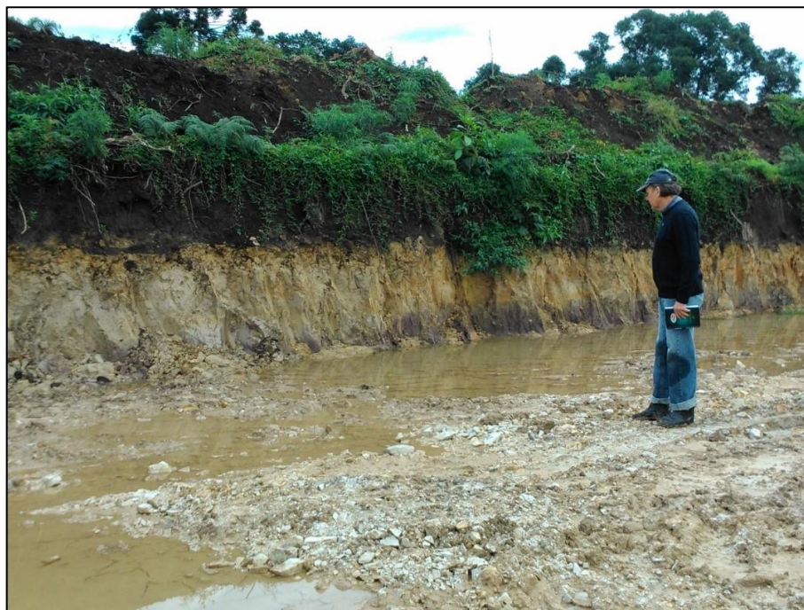
Figura 41: Detalhe de um local onde se observa que o aquífero freático está contido em um solo residual oriundo da alteração de rochas areníticas.
