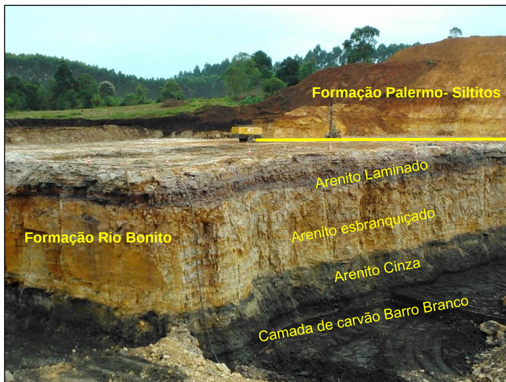
Figura 37: Aspectos da frente F em 2015. Na base do pacote arenoso ocorre a camada Barro Branco.
