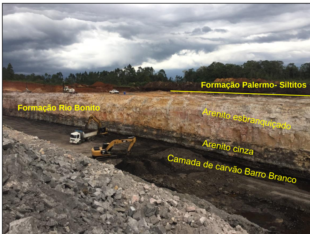
Figura 38: Vista em perfil da frente G. Na base do pacote ocorre a camada de carvão Barro Branco.
