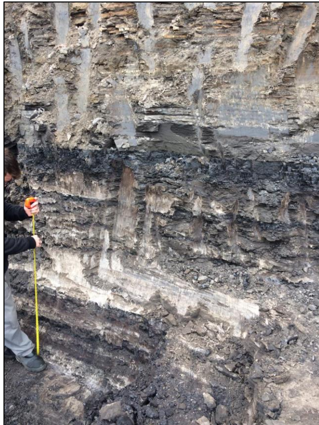
Figura 39: Detalhe da camada de carvão Barro Branco na frente G.
