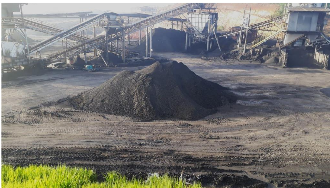
Figura 17: Finos do aerosseparador estocados no pátio da usina aguardando transferência para a Usina Lageado.
