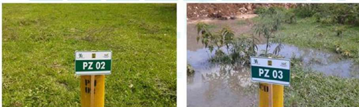
Figura 8.2 - Placas de identificação implantadas nos poços de monitoramento (piezômetros) na Mina Frente F
