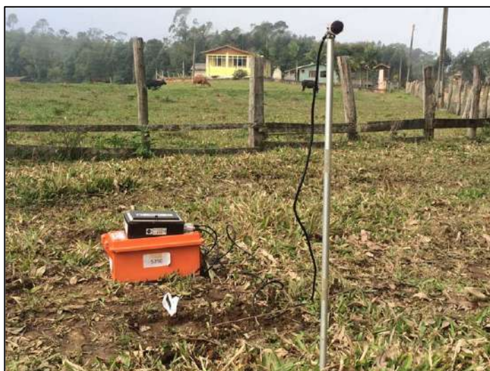
Figura 6.14 – Detalhes da instalação dos sismógrafos. Fonte: do autor.
