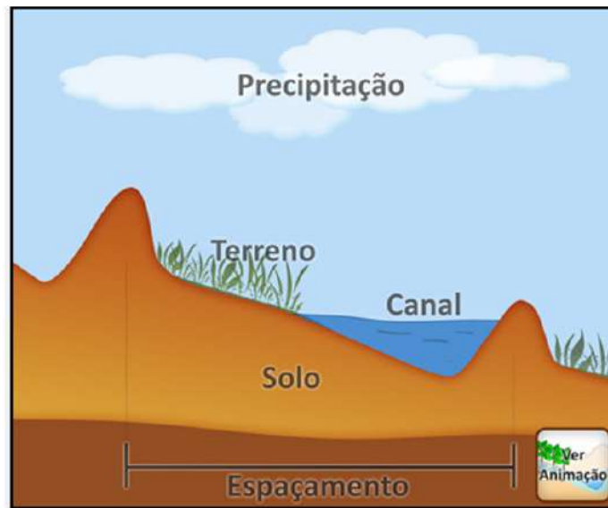
Figura 3.10 - Croqui de terreno com terraços construídos.
