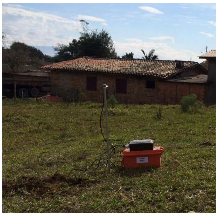
Figura 3. Detalhes da instalação dos sismógrafos.
