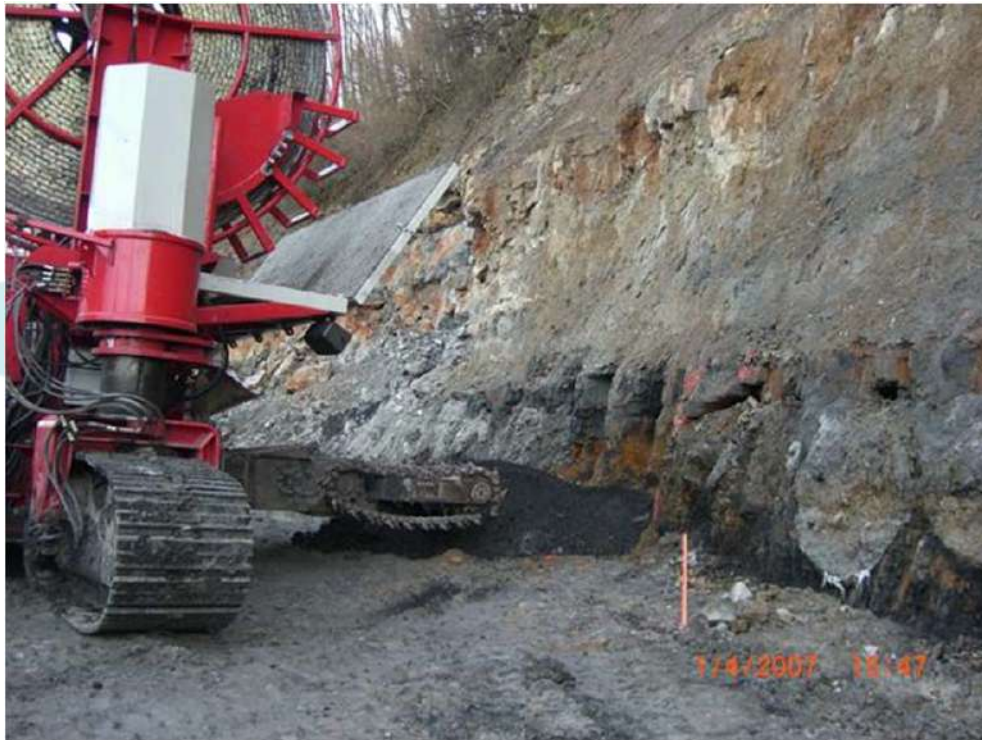
Figura 3.14 - Detalhe da ferramenta de corte de equipamento de lavra utilizado no método denominado high wall e das perfurações na camada de carvão. Fonte: http://www.coaleducation.org/technology/surface/images/
