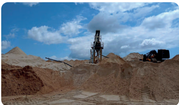
Local de armazenamento das areias fina e média e classificador no centro
