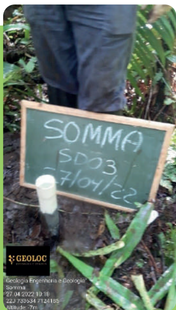
Poço provisório instalado na SD-03
