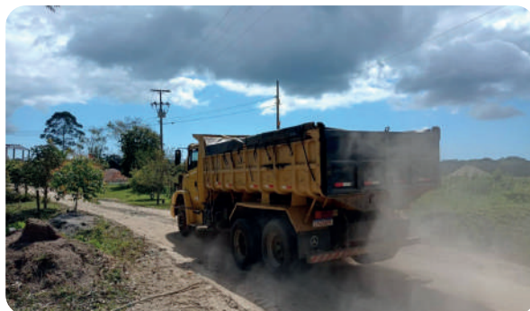
Caminhão carregado com areia dotado de proteção
