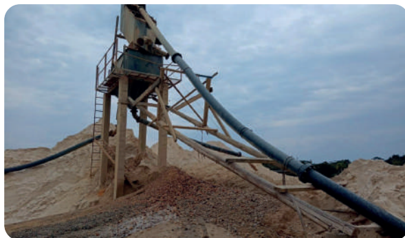
Classificador responsável por receber a areia e separar nas granulometrias fina e média
